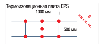
Установка крепежа сквозь армировочную сетку
